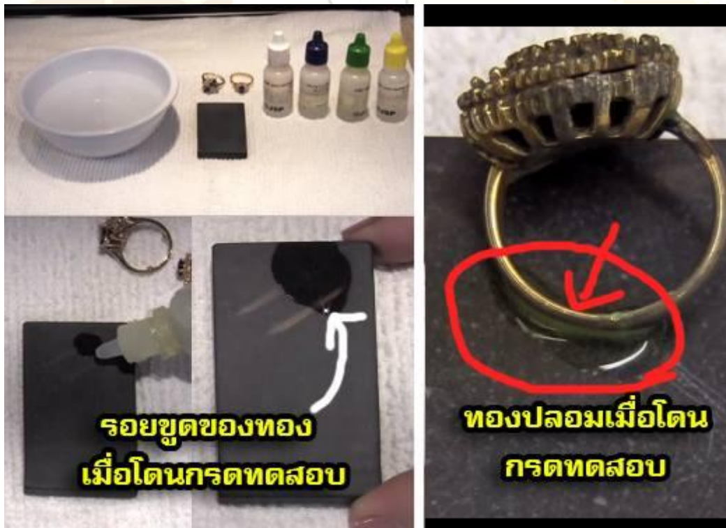
รูปที่ 1 การทดสอบทองด้วยหินทดสอบและกรด
