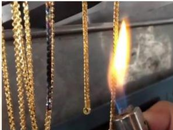
รูปที่ 2 การทดสอบทองด้วยวิธีการเผาไฟ (ที่มา https://www.banthonggold.com )
