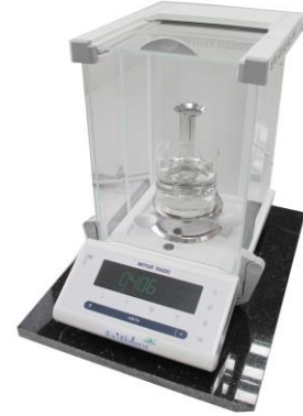
รูปที่ 1 เครื่องชั่งไฟฟ้าสำหรับหาความถ่วงจำเพาะ
